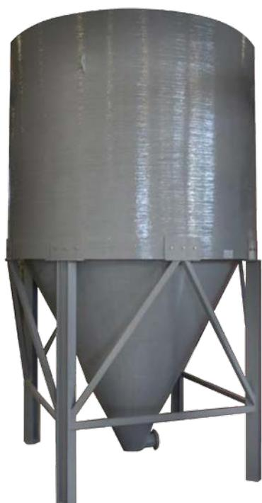
Su función es la de separar las pequeñas partículas en suspensión que aún quedan en la fracción líquida una vez separada. Al final se obtendrán 2 productos: un líquido limpio de sólidos y un producto espeso con un alto % de humedad. Los decantadores pueden ser lamelares o troncocónicos
