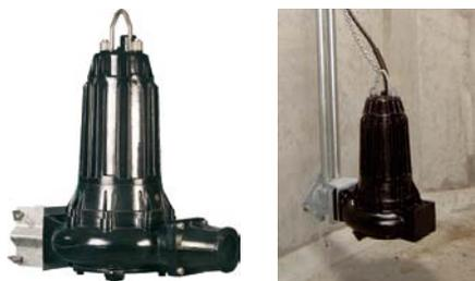
Estas bombas, provistas de rodetes multicanal abiertos para el paso de sólidos de tamaño medio y doble triturador en aspiración, están indicadas para usos particularmente pesados en los que se requiere una trituración previa de las sustancias sólidas o fibrosas contenidas en el líquido que se va a bombear.
