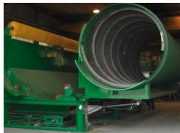
Criba basculante que permite un fácil mantenimiento. Incorpora cepillo rotativo que evita las obturaciones del tamiz
