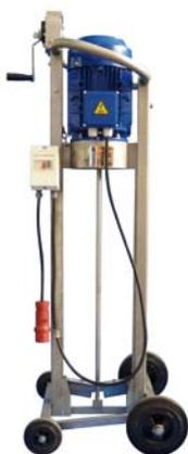
Diseñado para purín porcino, para agitar las fosas **sin tener que levantar las rejillas del suelo. Construido totalmente en acero inoxidable.** Por su diseño, es fácil de transportar y acceder a los lugares más difíciles.
