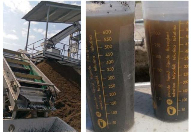
El equipo de separación está compuesto por una rampa con tamiz de malla Johnson y cepillos especiales antiroturas de flóculo.
