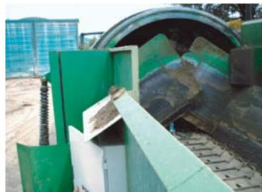
La entrega del producto al cilindro se realiza en diferentes tipos de cintas en función del material a separar
